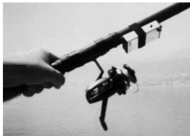
Signalizator za udičarenje zvučno i svjetlosno signalizira pojavu napetosti u nylonskoj niti, tj. aktivira se kada riba zagrize mamac. Koristi se pri ribolovu sa više štapova položenih u rašlje.
