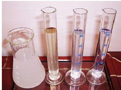
Inovirani postupak obrade otpadnih voda temelji se na fizikalno kemijskom postupku s optimiranim kemikalijama i to polialuminijevim kloridom i kalcijevim hidroksidom, s kojima se u pogodnom trenutku postiže vrlo dobra flokulacija, taloženje i bistrenje vode. Novi postupak obrade razvijen je u laboratoriju na originalnim uzorcima iz sirane, čije su vrijednosti opterećenja
