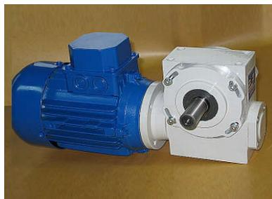
Regulacija zračnosti vrši se tako da se otpuste vijci poklopaca u kojima je uležišteno pužno kolo i zatim, odvijavanjem ili zavidavanjem regulacijskog vijka, namjesti željena zračnost nakon čega se vijci poklopaca stegnu.
