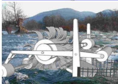
Vodeno kolo za minicentrale na rijekama i brzacima s promjenjivim vodostajem može se izvesti s velikom širinom u cilju što boljeg iskorištenja energije vodotoka. Optimalna dubina urona vodenog kola od presudne je važnosti za postizanje dobrog stupnja iskorištenja, održava se uz pomoć plovka na kraju poluge na kojoj je ležišteno vodeno kolo. Protututeg koji se puni vodom drži polužni sustav približno u ravnoteži, zbog smanjenja plovaka, pa i otpora koga oni pružaju strujanju iza kola.
