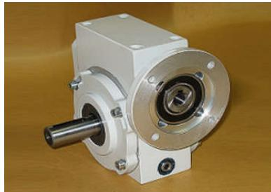
Reduktor s ugradenim vijkom za mikroregulaciju omogućuje regulaciju zračnosti između pužnog kola i pužnog vijka. Odvijavanjem ili zavidavanjem vijka za regulaciju, koji ima hod od 20.8 mm, mijenja se zračnost između pužnog kola i pužnog vijka od 0 do 0.25 mm.
