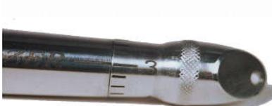
Zviždaljka za pse okretanjem kuglastog vrha preko osovinice s vijkom pokreće klip lijevo ili desno i tako povećava ili smanjuje volumen zračne komore u kojoj se proizvodi zvuk različite frekvencije, jačine i boje. Kugla na sebi ima skalu s brojkama, tako da se odabranim položajem u odnosu na kućište može dobiti uvijek isti zvuk u istom položaju.
