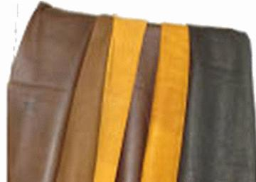
Ova ovčja i janjeća koža zadovoljava novi zahtjev na kvalitetu gotove kože: kao gotov proizvod može se prati na temperaturi 30°C uz upotrebu blagog sredstva za pranje. Postignut je obradom kože materija-lima temeljenim na hidrofobičnim i hidrofilnim elementima. Uz odgovarajuće izmjene moguće je dobiti i obućarske artikle.
