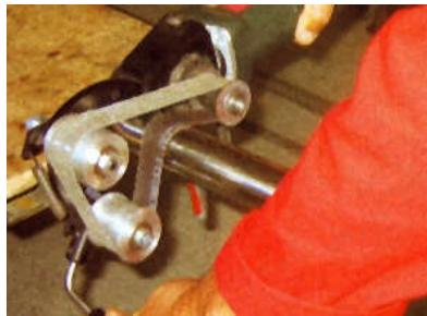
Naprava za brušenje i poliranje okruglih cijevi i koljena od inox-a, jednostavne je konstrukcije s malim brojem elemenata.
