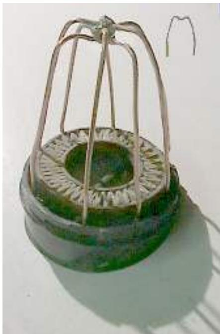
*Kostur se radi iz četiri „U“ komada smanjeno prikazanih u gornjem desnom uglu lijeve slike. Na plastičnoj korpi s koje smo odrezali mikrofilter, trebat će izbušiti osam pravilno raspoređenih rupa u koje cijanofiksom ulijepimo krajeve pripremljenih „U“ komada.*
